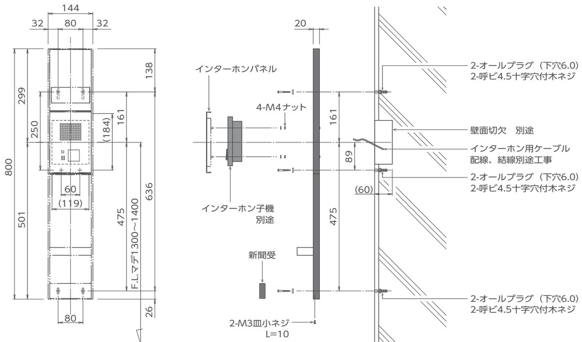
インターホンの配線・結線は電気設備工事。※壁埋込みは不可です。
