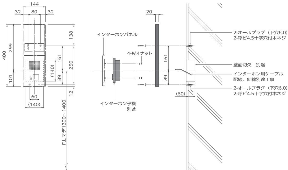
インターホンの配線・結線は電気設備工事。※壁埋込みは不可です。
