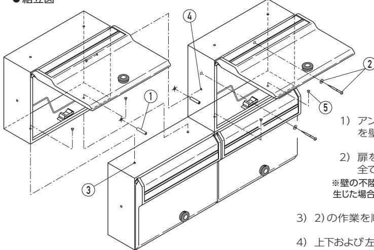
1) アンカーピッチ図にしたがいアンカープラグ①を壁に打ち込みます。(組立図参照)
